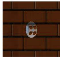
Com o auxílio de uma talhadeira ou serra copo, realize o furo central de encaixe do tubo. Com uma furadeira e broca de  $\varnothing 5\text{mm}$  realize os furos de fixação inserindo as buchas.
